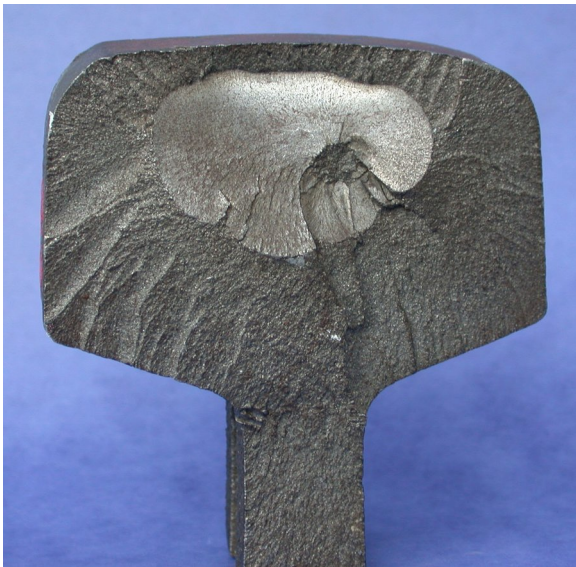
Figure 1 : Illustration d'un défaut interne.
