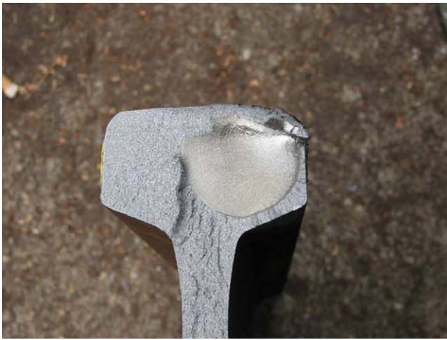
Fig. 6 Exemples de ruptures (sur rail et sur soudure)
